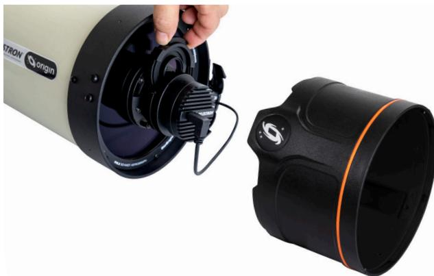
3. Agarre cuidadosamente el borde de la célula del filtro transparente y girelo en sentido antihorario. Desenrosque por completo y saque el filtro transparente del cajón. Guarde el filtro transparente en la funda incluida con el filtro Nebula cuando no lo use.
